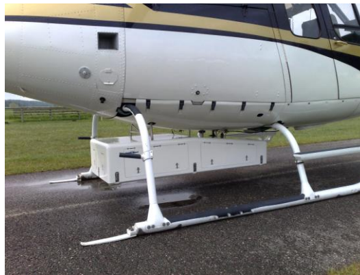
Abbildung 2-27: Aufnahmesystem mit Trägerplattform, Quelle: [GIS-Steiermark]
