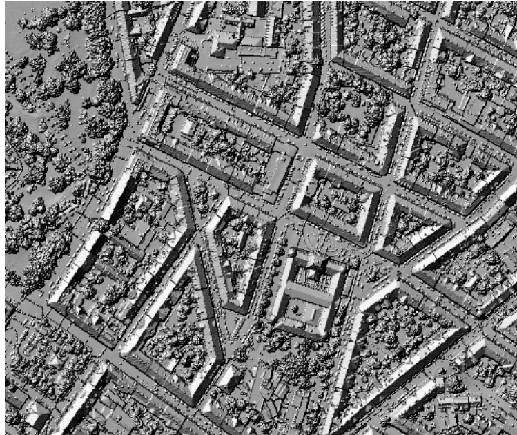
Abbildung 5-13: LAS-File (alle Klassen), Raster m. 0,5 [m] Auflösung, Interpoliert
