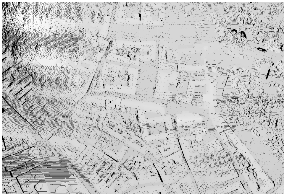
Abbildung 5-12: LAS-File (alle Klassen), Raster m. 0,5 [m] Auflösung, ohne Interpolation
