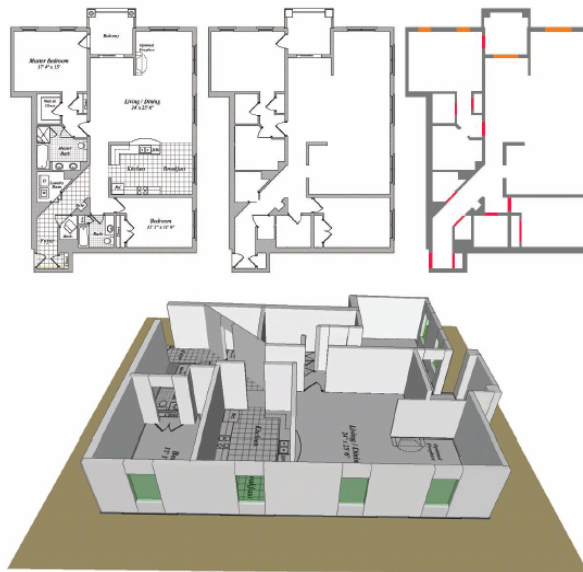
Abbildung 6: Erfassung von Gebäudemodellen aus CAD-Plänen (aus [YWR09])
