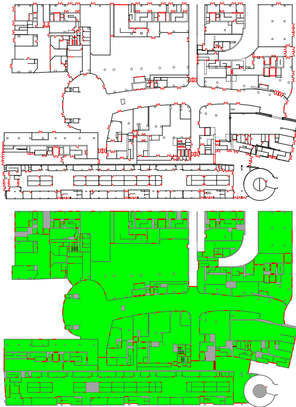
Abbildung 57: Aus einem CAD-Plan generiertes Modell eines Stockwerks
