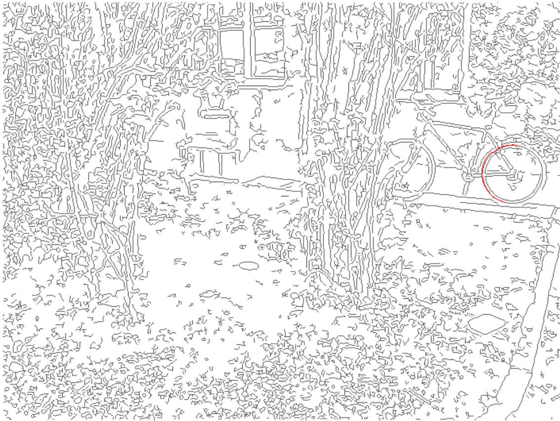
Abbildung 3.6: Beispiel eines Validierungs-Bildes des Fahrraddatensatzes mit stark strukturiertem Hintergrund. Die Kanten wurden mit einem Canny-Edge-Detektor berechnet. Das rote BF wurde im Bild mittels Chamfer-Matching (aufgeteilt auf 8 Orientierungs-Ebenen) gesucht, und an der Stelle mit der geringsten Distanz eingezeichnet.
