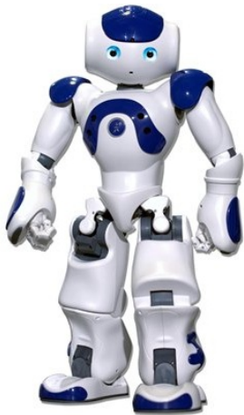
(a) Ein humanoider Roboter der Firma Aldebaran. Eingesetzt wird er hauptsächlich in der Forschung und im Robo-Cup, einem Fußballturnier für Roboter.
