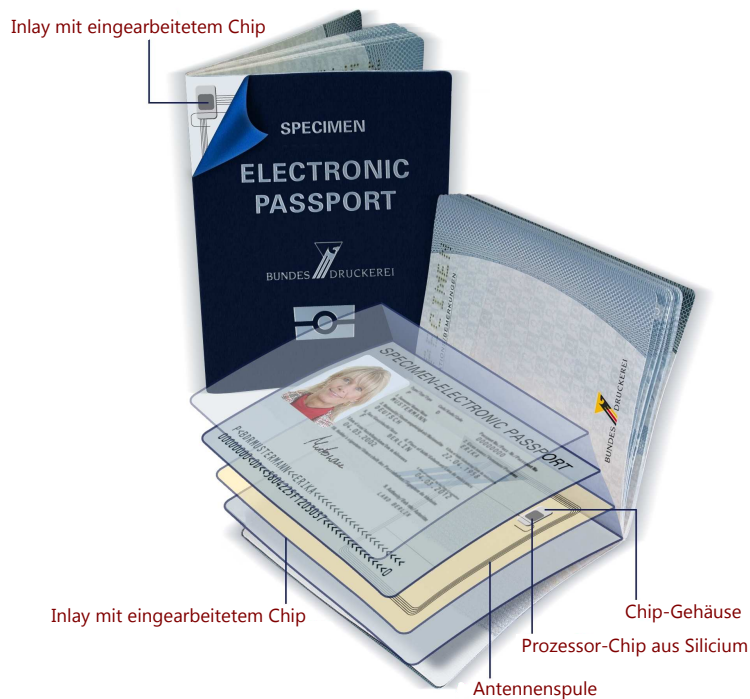
Abbildung 1.1: Aufbau eines elektronischen Reisepasses, modifiziert aus [Bun]
