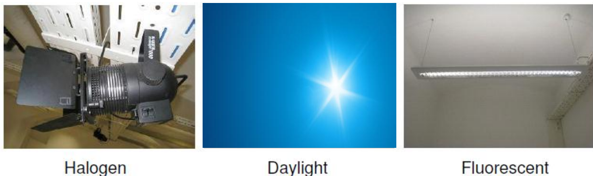
Abbildung 4.3: Die Farbkonstanzversuche wurden mit den abgebildeten Lichtquellen (Halogen-, Tages- und Leuchtstoffröhrenlicht) durchgeführt.
