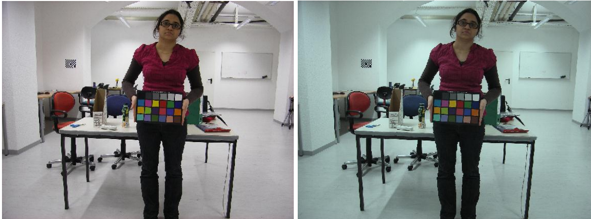
Abbildung 5.6: Wie zuvor (siehe Abbildung 5.3) wurde auch hier auf die Farben des Targets bei ungleichförmiger Beleuchtung kalibriert. Diesmal wurde die Farbkalibrierung jedoch mit den normalisierten RGB-Werten durchgeführt, wodurch Clippingeffekte verhindert werden konnten (vgl. die Kontur der Türe im Hintergrund mit jener in Abbildung 5.3). Der leichte Blaustich der im rechten Bild erkennbar ist, erklärt sich dadurch, dass bei der Kalibrierung die Abweichungen zu allen sieben Patches (Blau, Grün, Rot, Gelb, Magenta, Cyan, Weiß) gleichermaßen minimiert wurden. Wenn man fordert, dass die Differenz zum weißen Patch null ist, und zu den anderen Patches so klein wie möglich, ist das Bild nach der Kalibrierung visuell gesehen "schöner" (siehe Abbildung 5.7).
