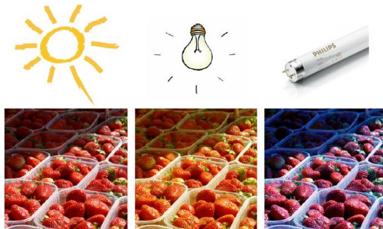
Abbildung 2.6: Obwohl für alle drei Aufnahmen dieselbe Kamera mit denselben Einstellungen verwendet wurde, werden die Farben, von der Beleuchtung abhängig, unterschiedlich dargestellt. (angepasst von [34])
