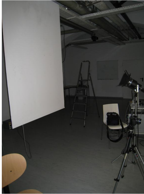
Abbildung 4.4: Damit eine möglichst gleichförmige Beleuchtung sichergestellt werden konnte, erfolgte die Halogenbeleuchtung indirekt über eine weiße Leinwand.
