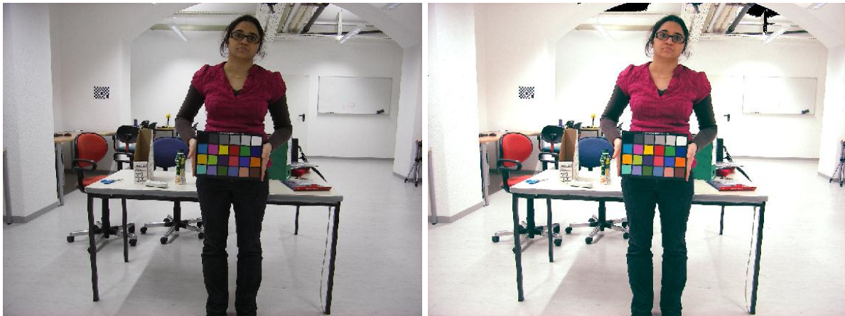
Abbildung 5.3: Die dargestellten Bilder zeigen eine Szene, die bei ungleichförmiger Beleuchtung fotografiert wurde. Das unbearbeitete Originalbild, welches mit einer Canon IXUS 860 IS aufgenommen wurde, befindet sich links. Rechts sieht man wie das Bild der Szene aussieht, wenn man auf die Farben des Targets kalibriert. Speziell an der Kontur der Türe, welche sich im Hintergrund befindet, kann man erkennen, dass einzelne Farbwerte in die Sättigung geraten sind.
