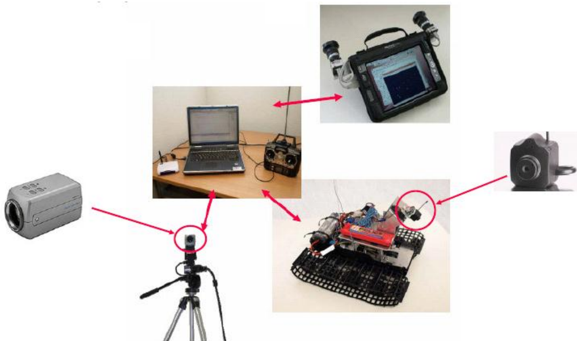
Abbildung 4.1: Für die Farbbildaufnahme stehen eine DFW-VL500 Sony Zoomkamera (mitte links), eine IDS Stereokamera (2 uEye Kameras vom Typ UI-1220-C) (oben rechts) und eine Magic Eye WLAN Kamera (mitte rechts) zur Verfügung. Zusätzlich werden auch eine Canon IXUS 860 IS und eine Olympus E-510 verwendet.
