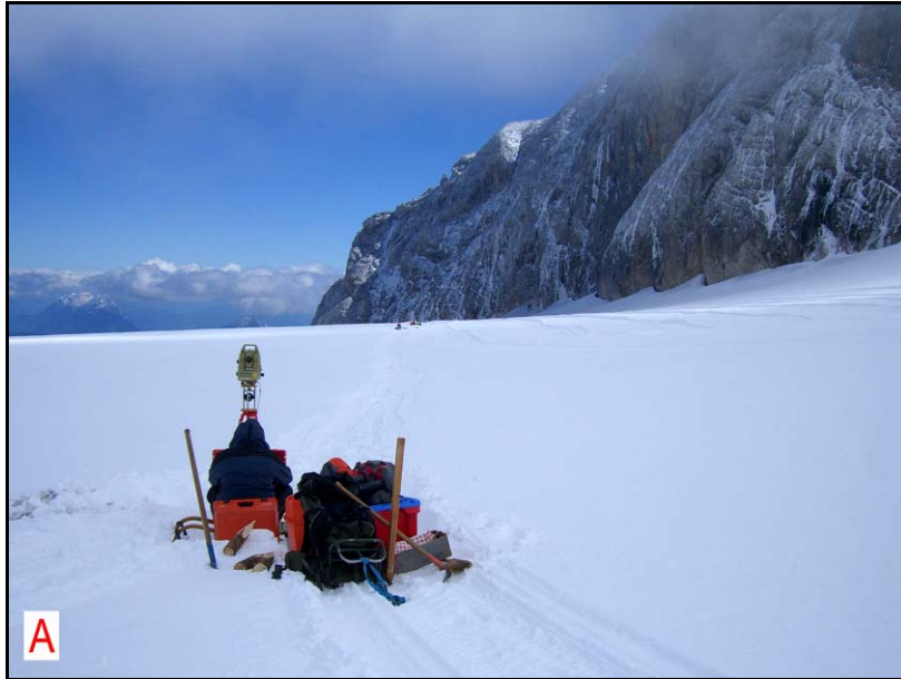
Abbildung 4-12, Tachymeter-Station A (West) auf Eisunterlage
