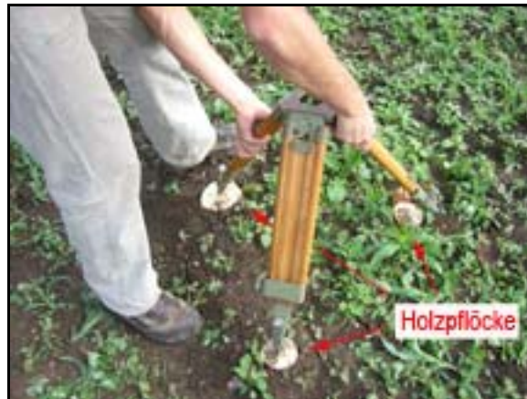
Abbildung 4-5, Stabilisierung der Stativbeine auf Holzpflocken
