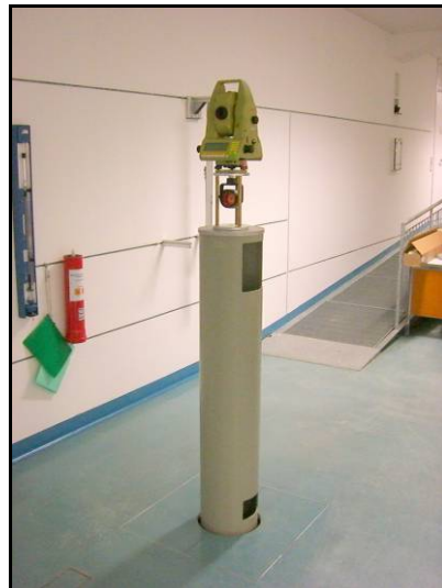
Abbildung 3-34, Tachymeter A auf einem der verwendeten Messpfeiler im Messlabor des IGMS
