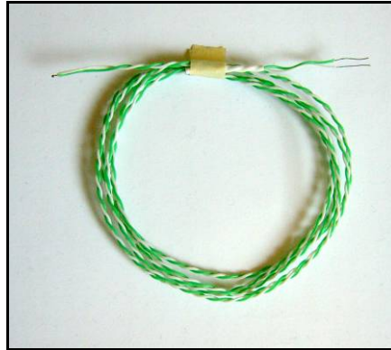
Abbildung 3-7, Thermoelement Typ K (RS-Components), Grün = Nickel/Chrom, Weiss = Nickel/Aluminium
