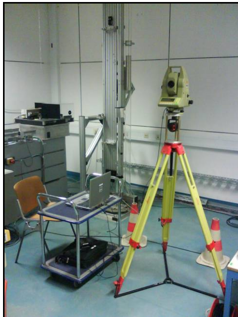
Abbildung 3-25, Aufbau einer Station zur gegenseitig-gleichzeitigen Zenitwinkelmessung im Messlabor des IGMS
