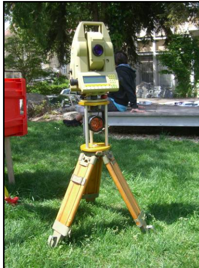
Abbildung 4-2, Aufbau einer Tachymeter-Station mit Ministativ (Campus Steyrergasse)
