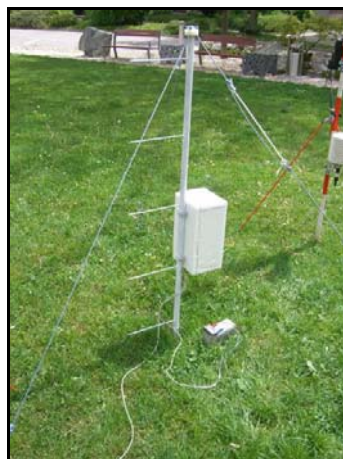
Abbildung 4-3, Temperaturmast zur Gradientenmessung (Campus Steyrergasse)
