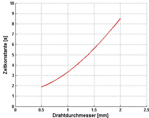
Abbildung 3-2, Zeitkonstante von Thermoelementen mit verschiedenem Durchmesser (Omega 2007, Z-51)
