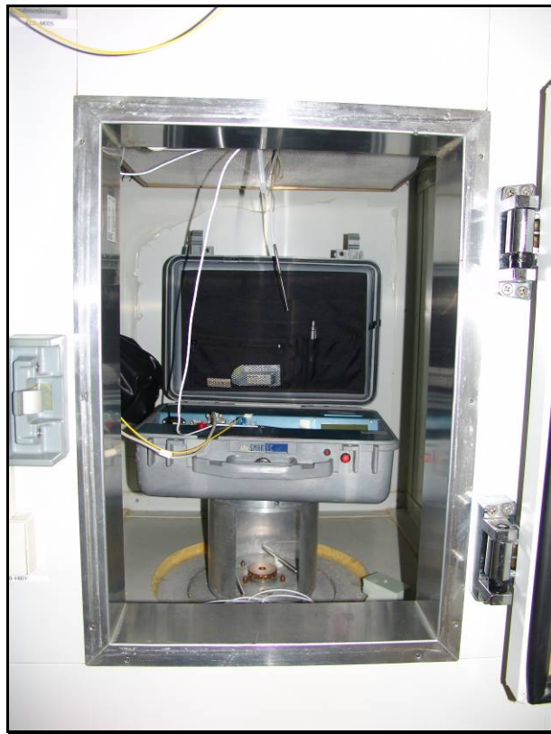
Abbildung 5.13: SOFO Static RU in der Klimabox
