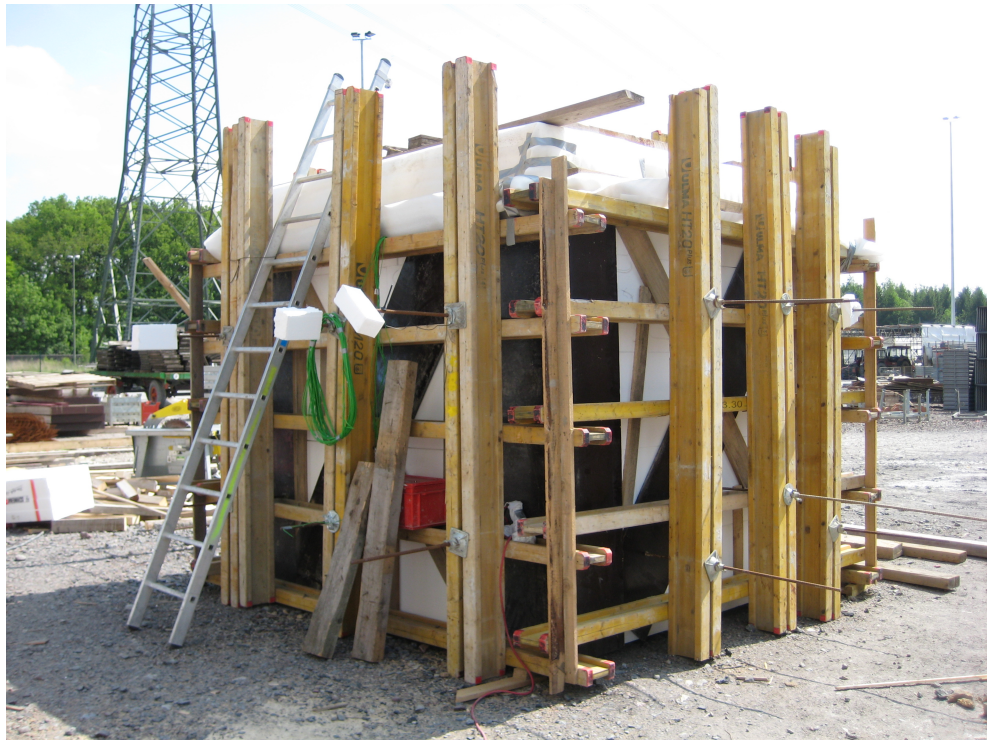
Abbildung 2.3: Probewürfel für teiladiabatischen Kalorimeterversuch
