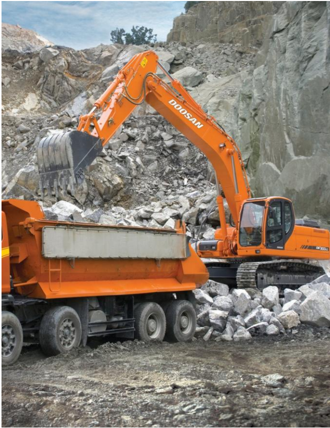
Abbildung 27: Kettenbagger Doosan DX 300 LC 220
