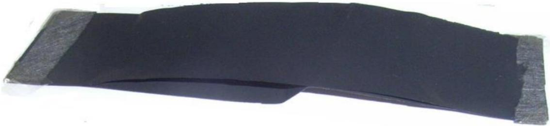
Abbildung 2.5: Gewölbte MEA nach der Messung mit Verwendung der BPP aus Abbildung 2.4
