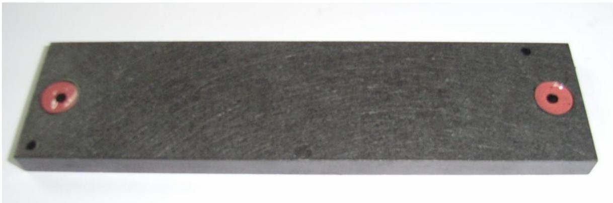
Abbildung 4.20: BPP, auf deren Gasanschluss die zwei geschnittene Dichtungen liegen.
