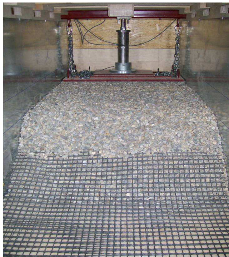
Abb. 11.6 Verdichtung des Schüttstreifens mit Geokunststoffgitter
