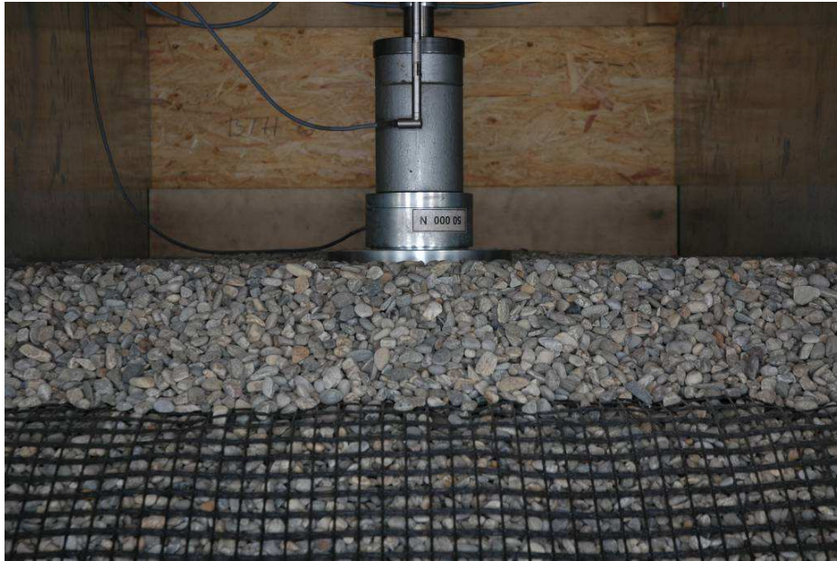
Abb. 11. 7 Prüfung des Schüttstreifens mit Geokunststoffgitter
