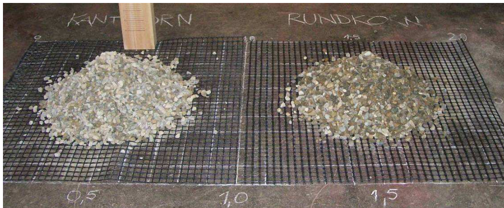
Abb. 4. 5 Schüttkegel mit Geokunststoffgitter am Boden
