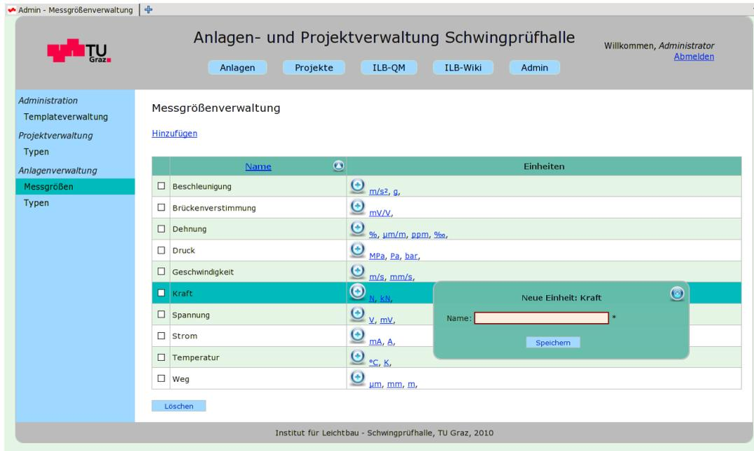
Abbildung 6.3: zeigt einen Überblick und die Administration über alle aktuellen Messgrößen sowie deren Einheiten mit der Möglichkeit, Messgrößen inklusive Einheiten oder einzelne Einheiten zu löschen. Das Fenster „Neue Einheit: Kraft“ erscheint nach Klick auf den add Button neben der Einheit Newton (N). In diesem Fenster kann eine neue Einheit für die Messgröße Kraft hinzugefügt werden.
