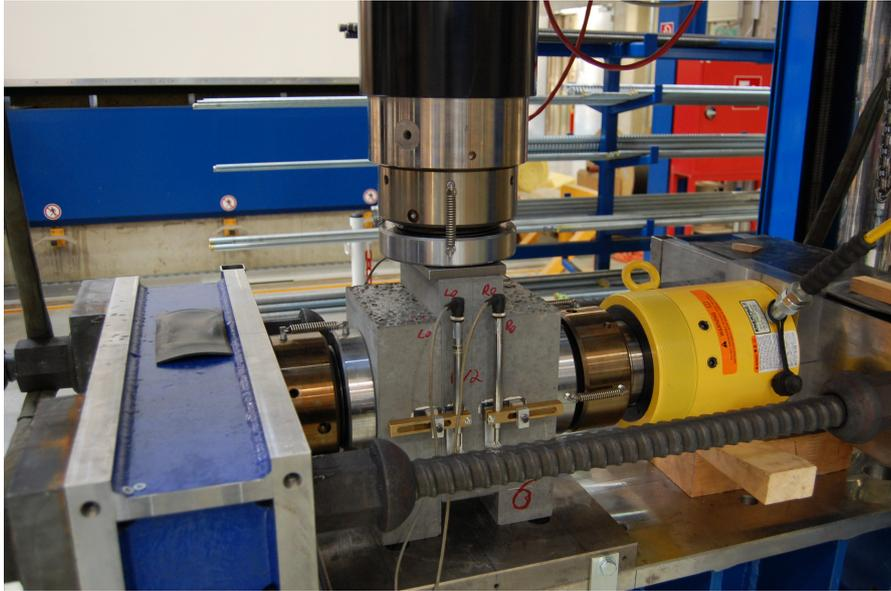
**Abbildung 3.2:** Aufbau des Reibversuchs
