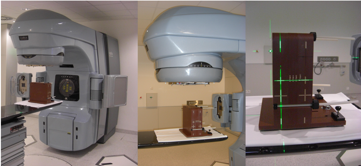
Abbildung 5.2: Das Mess-Setup am LINAC. Das MEDTEC-Phantom befindet sich auf der Patientencouch. Film (nicht sichtbar) befindet sich im Phantom. Die Einstellung mit Hilfe des Laserpositionierungssystems ist ebenfalls gezeigt (rechts).
