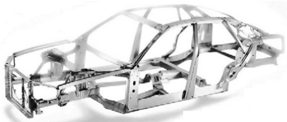
Abbildung 11: tragende Bauteile der Fahrgastzelle am Beispiel des Space Frame von AUDI [1]
