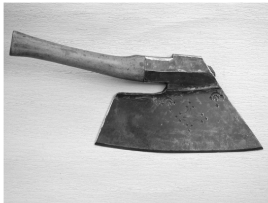
Abb. 3.2: Bearbeiten mit Breitbeil (links), Breitbeil (rechts)
