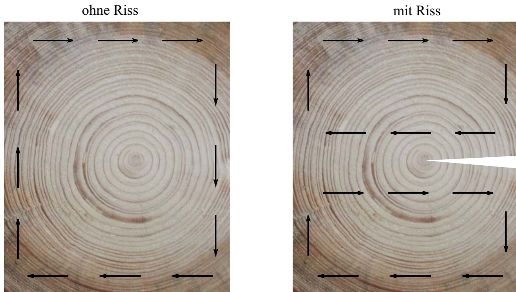
Abb. 10.14: Schubfluss unter Torsionsbeanspruchung
