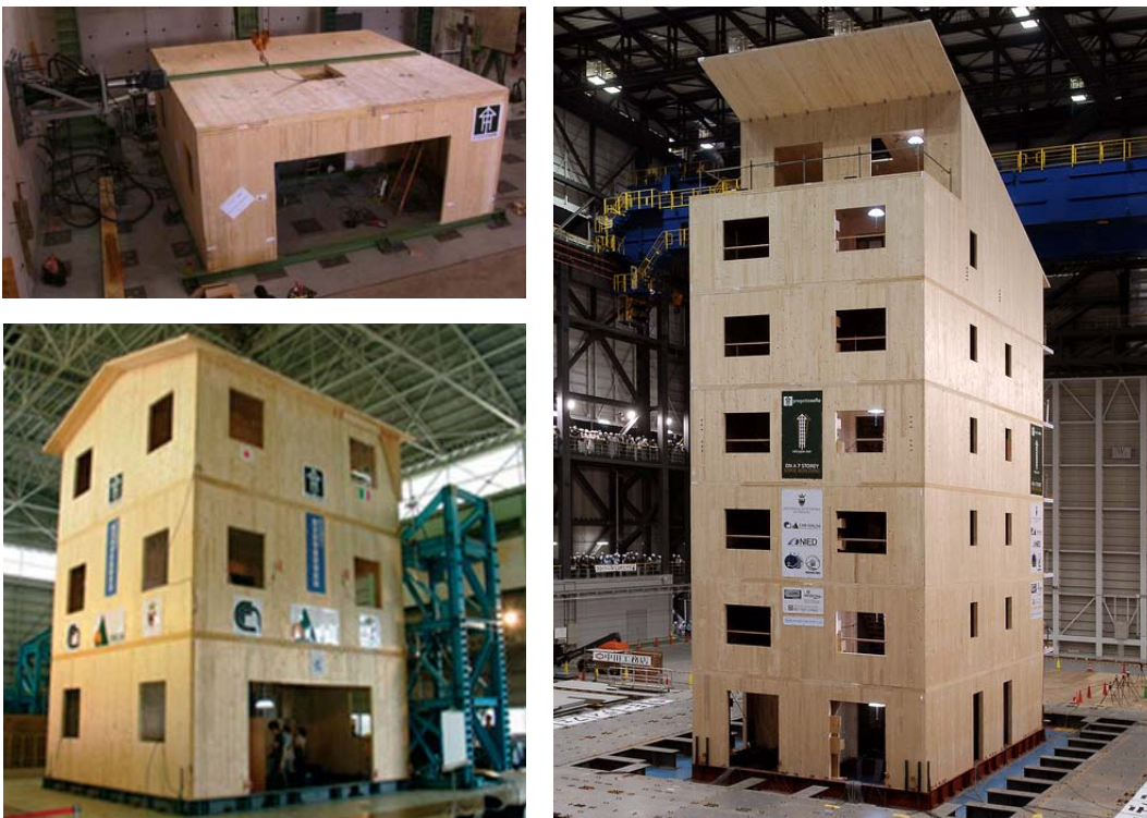
Abb. 7.1 Projekt „SOFIE“: links-oben: pseudodynamischer Versuch an einem Stockwerk [26] links-unten: dreistöckiges Versuchsobjekt [27] rechts: siebenstöckiges Versuchsobjekt [53]
