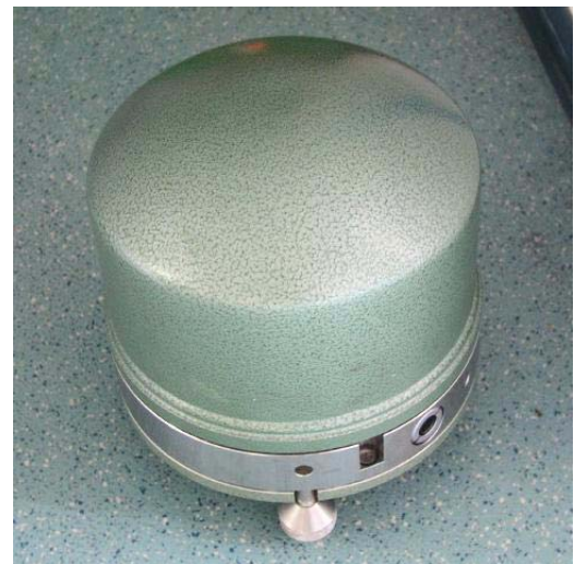
Abb. 2.2 links: erstes Erdbebenmessinstrument von Chang Heng 132 n. Chr. [51] rechts: Seismograph heute [52]
