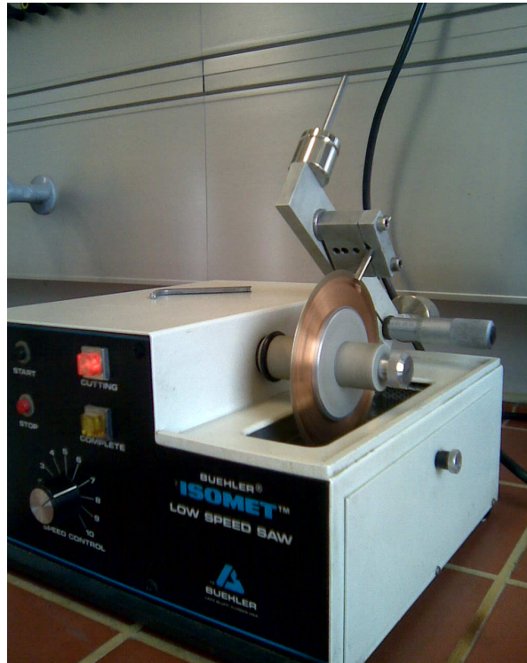
Abbildung 3.2: Bühler ISOMET Low Speed Saw mit Diamantsägeblatt beim Längsschnitt einer Probe.
