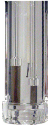
Abbildung 4.18: Der Probenhalter des Schubstangendilatometers (L75VX) gut zu erkennen sind die beiden Schubstangen aus Quarzglas und das Thermoelement.[25]
