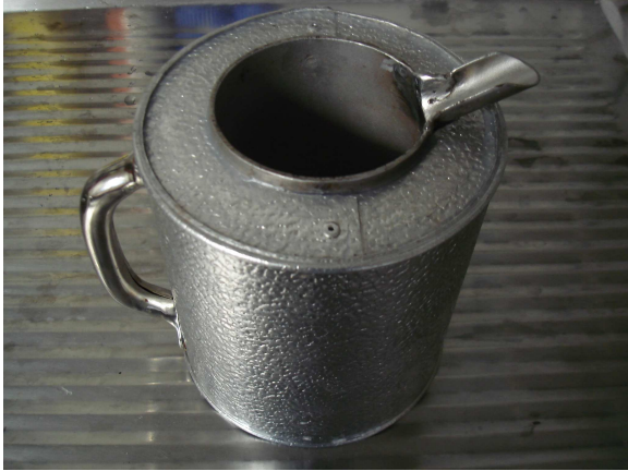
Abbildung 6-1: Isoliertes Probenahmegefäß für die heiße Schmelze
