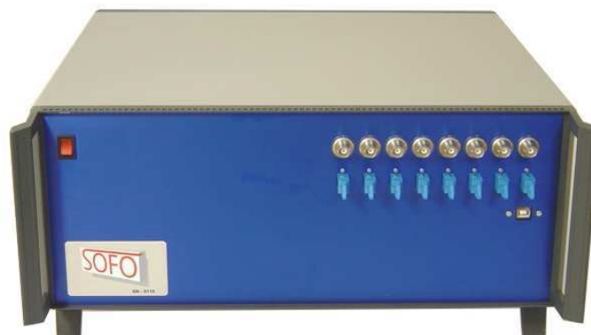
Abbildung 3.1: SOFO Dynamic Reading Unit (siehe Anhang E.1)
