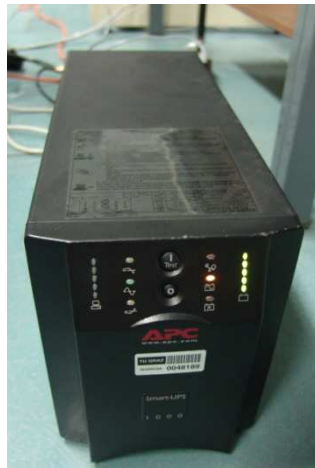
Abbildung B.4: Verwendete USV - APC SMART-UPS 1000
