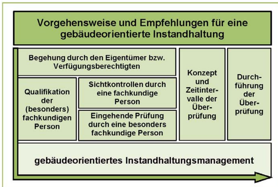
Abbildung 3-9 Vorgehensweise für gebäudeorientiertes Instandhaltungsmanagement
