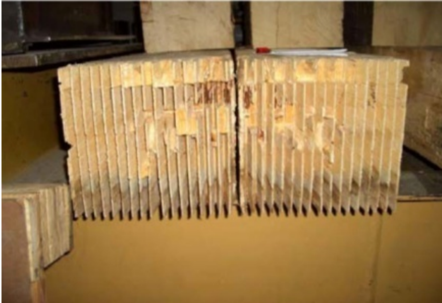
Abbildung 3-4 Keilzinkenverbindung eines Untergurtes 45
