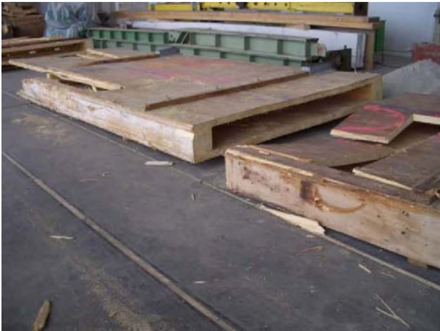
Abbildung 3-3 Querschnitt eines der verwendeten Dachbinder 43
