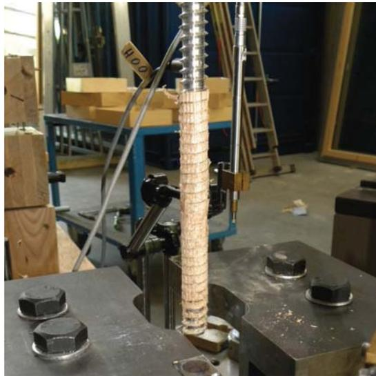
Abbildung 18: Spiralenförmiges Abscheren der Fasern
