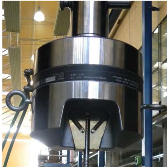
(b) Klemmeinrichtung für  $d = 20$  mmAbbildung 16: Adaption der Prüfvorrichtung für  $d = 20$  mm
