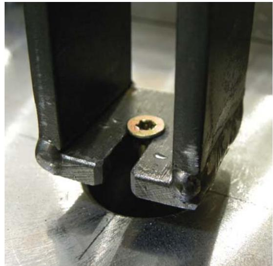
(b) Schraubenhalterung für  $d = 4$  mm
