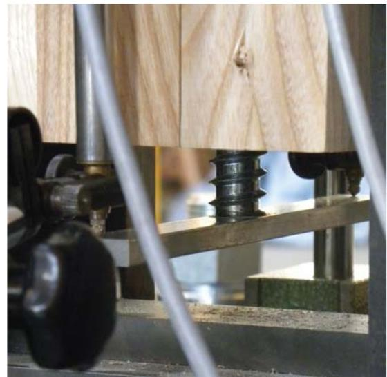
(b) Messeinrichtung unterhalb des Prüfkörpers
