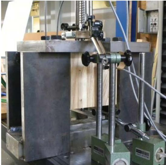
(a) Prüfvorrichtung für  $d = 20$  mm
