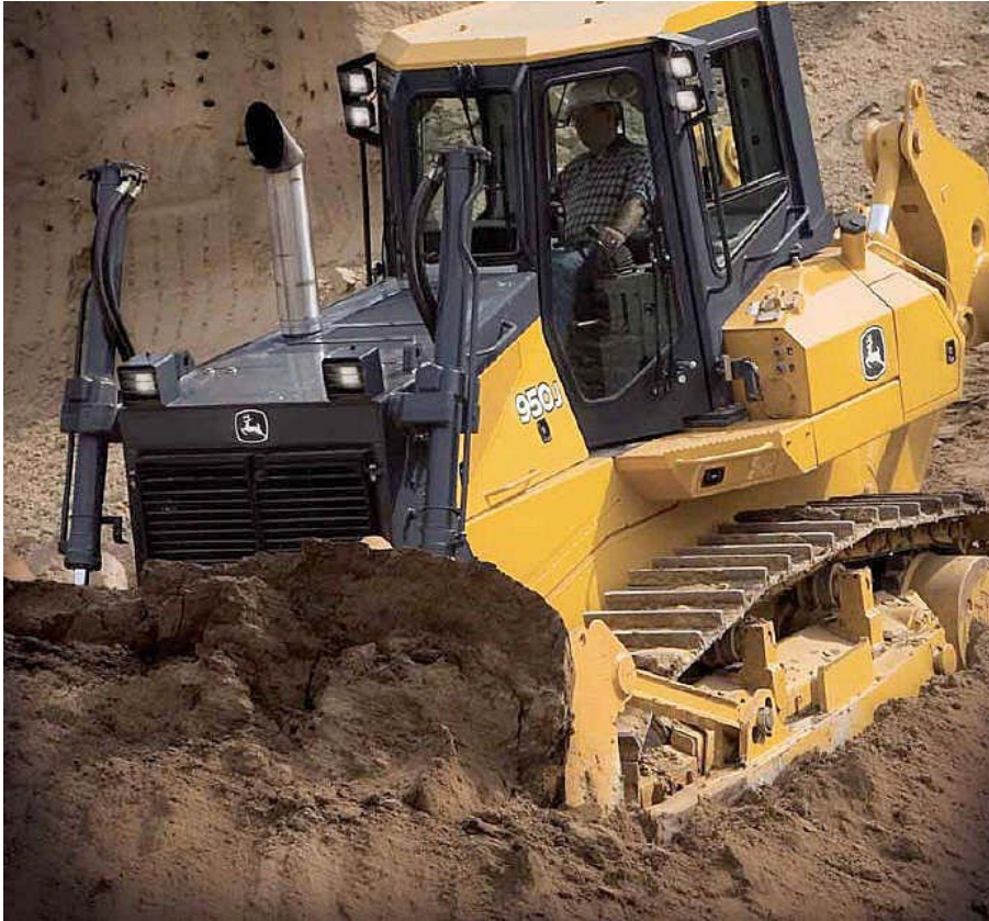
Bild 6.17 Planierraupe 950J der Firma John Deere im Arbeitseinsatz 44
