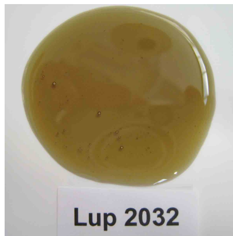
Abbildung 32: Bei T = 215 \text{ °C} und t = 2 \text{ h} mit Polyol B aufgeschlossenes Recyclat.
