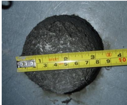
Abbildung 39: Ausbreitmaßmessung von UHPC mit 1,5 Vol.% Carbonfasern
