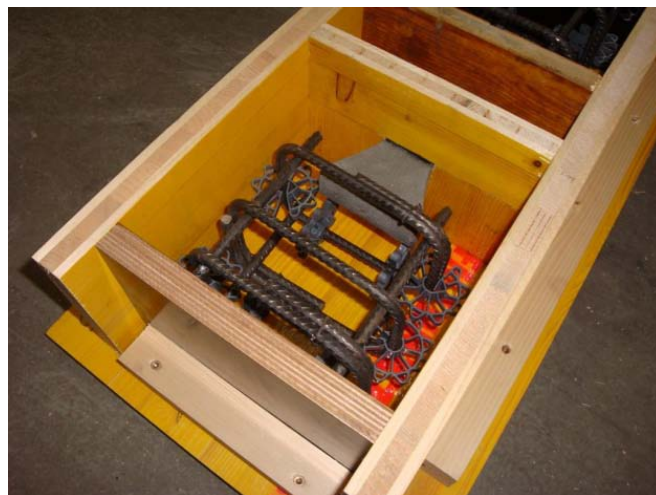
Abb.5-4: Versuchskörper V3 vor Normalbetonfüllung
