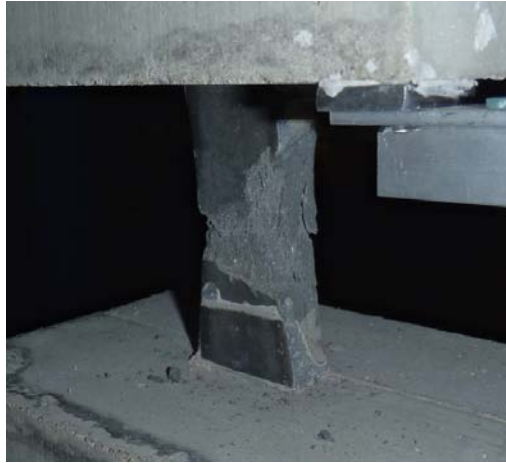
Abb.5-11: Exemplarische Darstellung Versagensbild Druckelement
