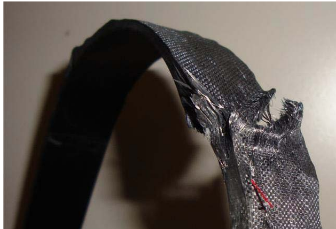
Abb.2-21: Bruch an einer Falte (exemplarisch)
