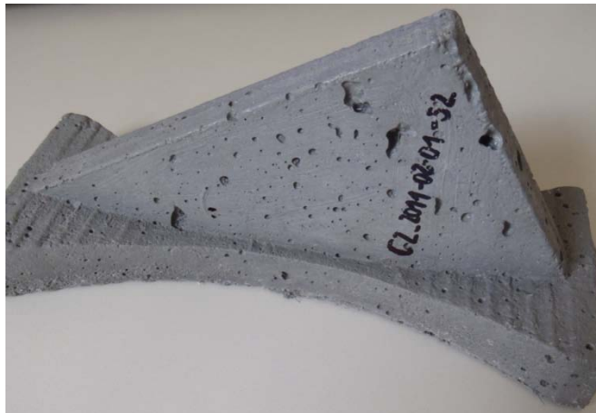
Abb.5-1: Ergebnis Betonage C2
