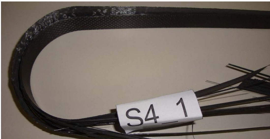
Abb.3-6: Versagensbild Versuskörper S4_1
