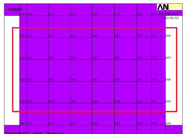
Abbildung 6.12: Knotenelementen für Pfeiler 2 [37]
