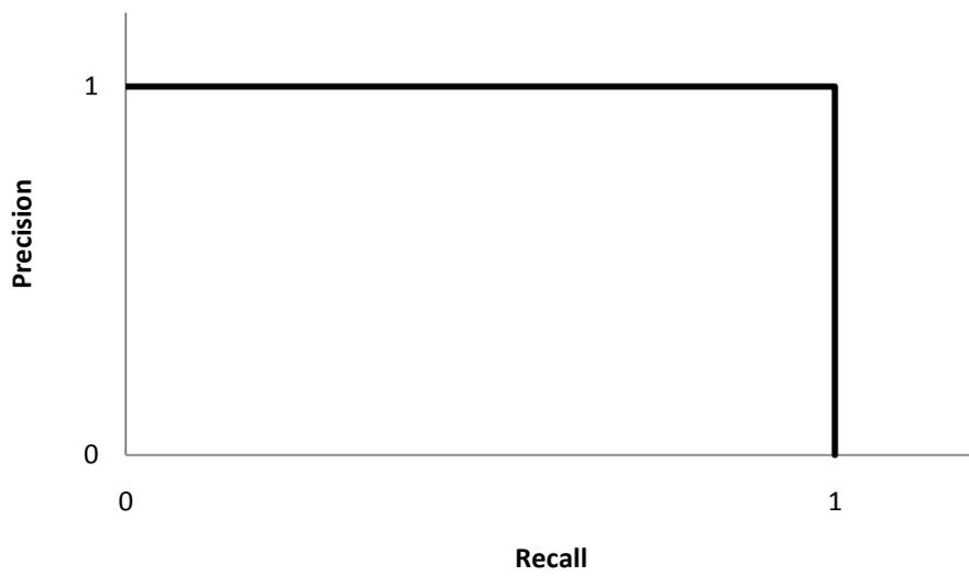
Abbildung 20: Ideales Precision-Recall-Diagramm [6]
