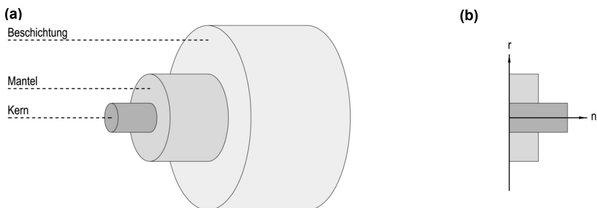
Abbildung A-1: (a) Schematischer Aufbau eines Lichtwellenleiters, (b) Brechungsindexverlauf
