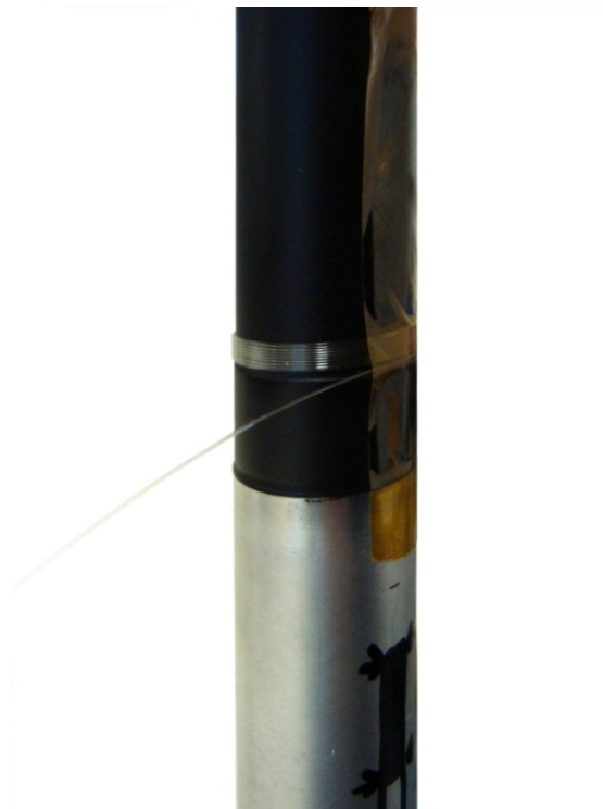
Abbildung 59: Um ein Rohr ( \varnothing 19\text{mm} ) gewickelte Faser
