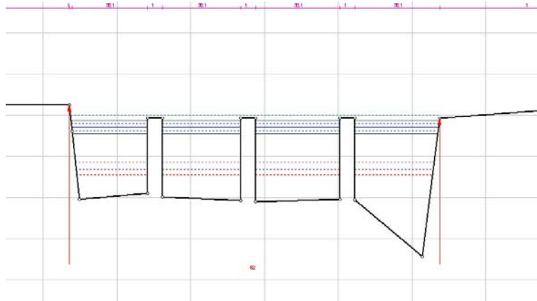
Abbildung 1.17: Brücken als Geländeprofil in Waspri
