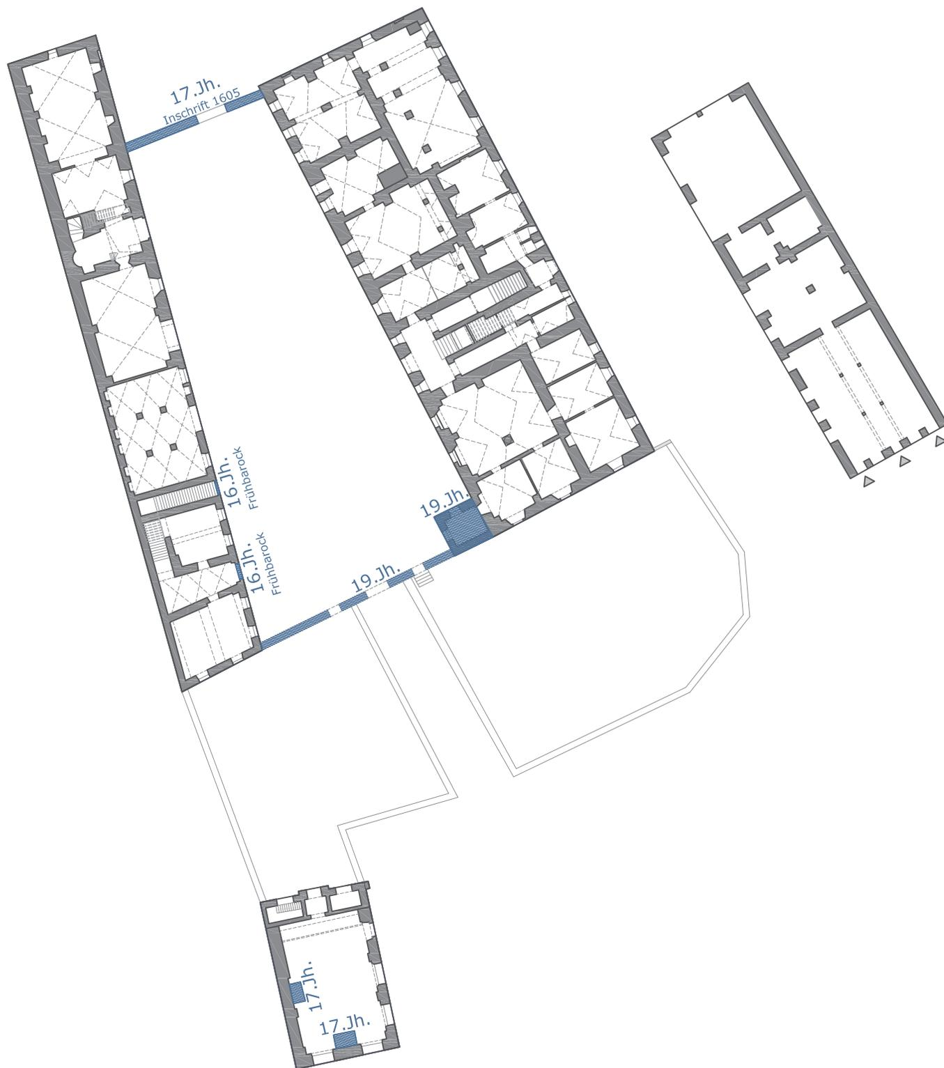
Abb. 15: Zeitpunkt der Errichtung, Erdgeschoss
