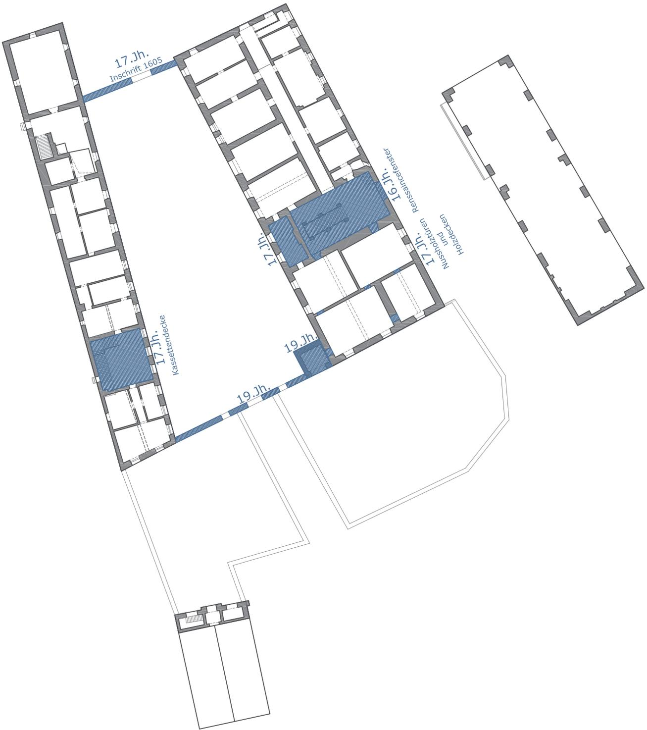
Abb. 16: Zeitpunkt der Errichtung, Obergeschoss
