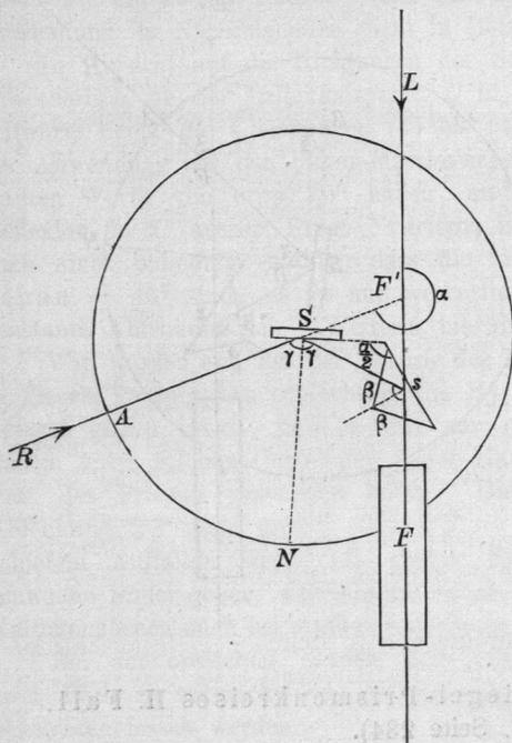
Da übrigens ein Winkel  $L - R = 280^\circ$  nichts anderes ist als ein Winkel  $R - L = 360^\circ - 280^\circ = 80^\circ$ , so heisst das Resultat in anderen Worten: von  $0^\circ$  bis  $180^\circ$  lassen sich Winkel in Lage I messen, und ausserdem von  $80^\circ$  bis  $180^\circ$  Winkel in Lage II. Je nachdem dann die Zielpunkte ungleich beleuchtet sind, kann man zwischen  $80^\circ$  bis  $180^\circ$  den Fall I oder den Fall II wählen.
