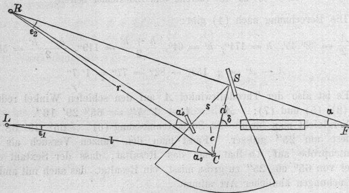
Da es sich immer um weite Entfernungen handeln wird, wollen wir die Abstände  $l$  und  $r$  der Zielpunkte links und rechts in Kilometern nehmen, und deswegen auch  $e$  und  $d$  in diesem Maasse einsetzen, d. h.:
