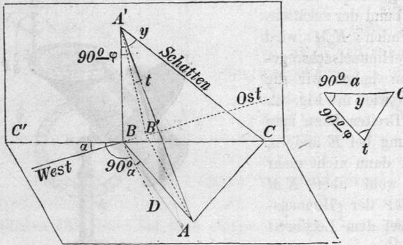
Die Richtung  $y$  eines Nachmittagsschattens  $A'C$  gegen die Verticale  $A'B$  erhält man aus einem Dreieck, dessen Spitze in  $A'$  und dessen drei Strahlen  $A'B$ ,  $A'C$  und  $A'A$  sind. Das entsprechende sphärische Dreieck ist in Fig. 4. rechts besonders gezeichnet und gibt durch Anwendung der Formel (8) § 1. S. 2:
