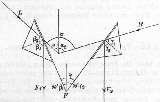
einander gestellt, und denken uns den Winkel  $\alpha$  zwischen den Strahlen  $L$  und  $R$  dadurch gemessen, dass  $L$  am linksseitigen Prisma nach  $F_1$  und  $R$  am rechtsseitigen Prisma nach  $F_2$  reflectirt wird, so dass  $F_1$  und  $F_2$  parallel, d. h. bei übereinander gestellten Prismen zusammenfallend werden.
