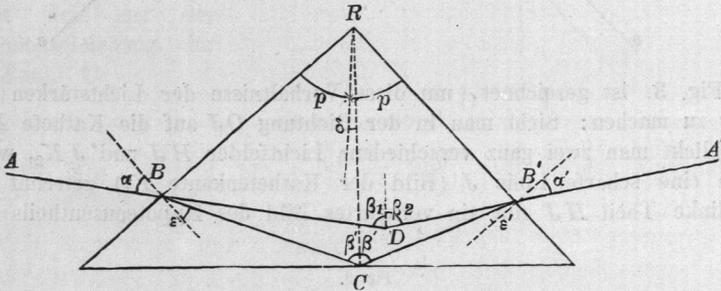
solches Prisma, welches nicht genau einen rechten Winkel, sondern einen Winkel  $2p$  hat, dessen Halbierungslinie mit der Normalen zur Hypotenuse den kleinen Winkel  $\delta$  macht, wodurch auch die Ungleichheit  $2\delta$  der beiden spitzen Prismenwinkel bestimmt ist. Für den Weg eines Strahls  $AA'$  bekommt man:
