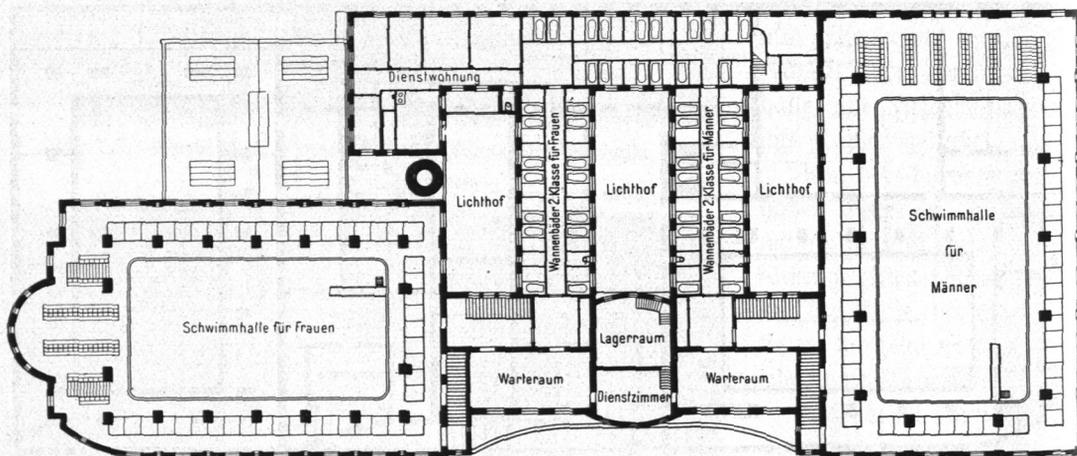
Abb. 754. Badeanstalt Hammerbrook, Obergeschloß, Grundriß.
