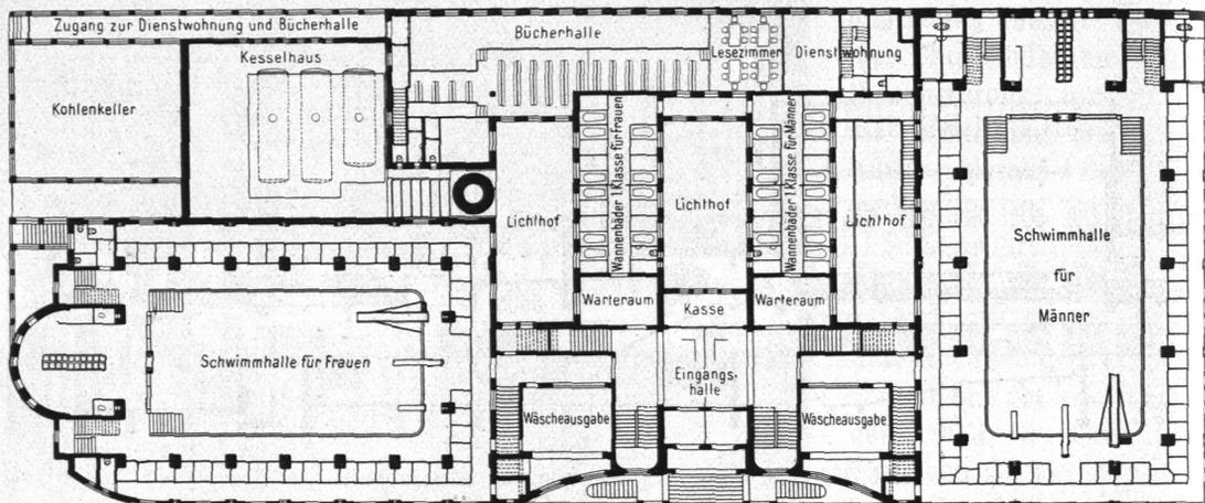
Abb. 753. Badeanstalt Hammerbrook, Erdgeschloß, Grundriß.
