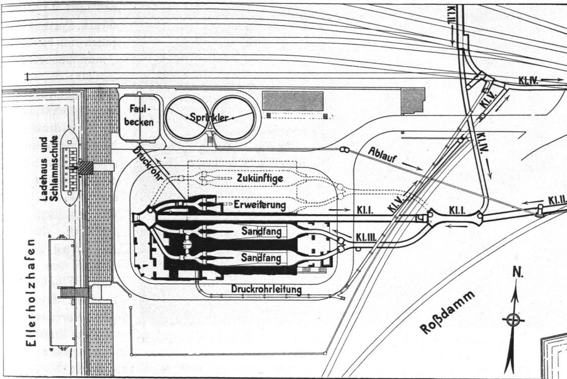
Abb. 637. Abfischanlage des südlichen Elbufers, Lageplan der Gesamtanlage.
