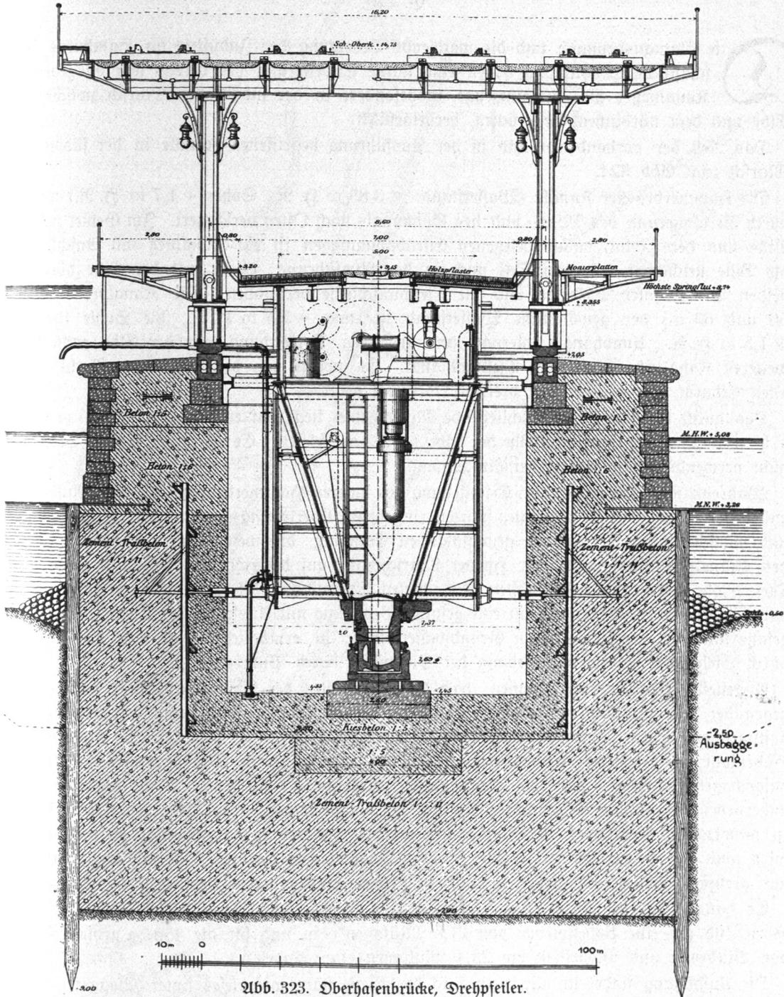
Abb. 323. Oberhafenbrücke, Drehpfeiler.
