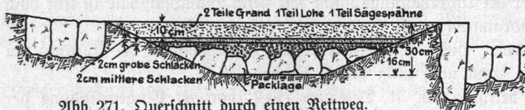
Abb. 271. Querschnitt durch einen Reitweg.
