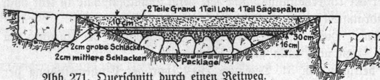
Abb. 271. Querschnitt durch einen Reitweg.
