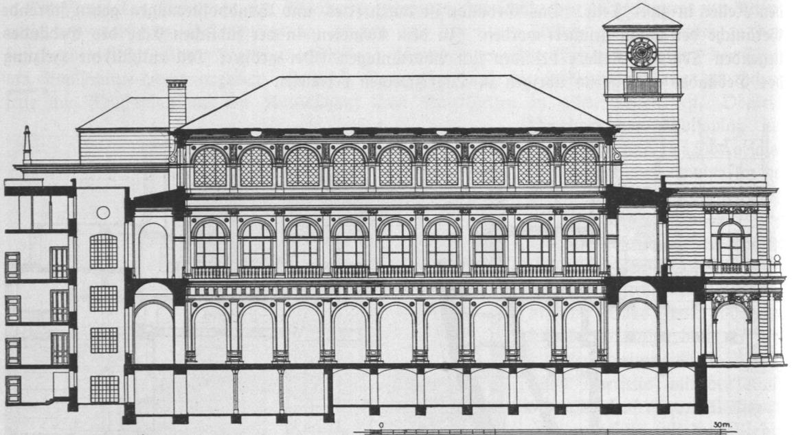
Abb. 76. Börse, Längsschnitt durch den östlichen Anbau.
