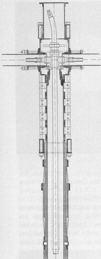
Abb. 10. Vorläufiger Verschluss der Bohrung.
