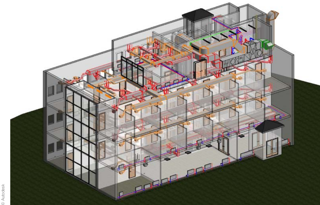
Abbildung 2: Planung gebäudetechnischer Systeme mit einer BIM (Building Information Modelling)-Plattform.
