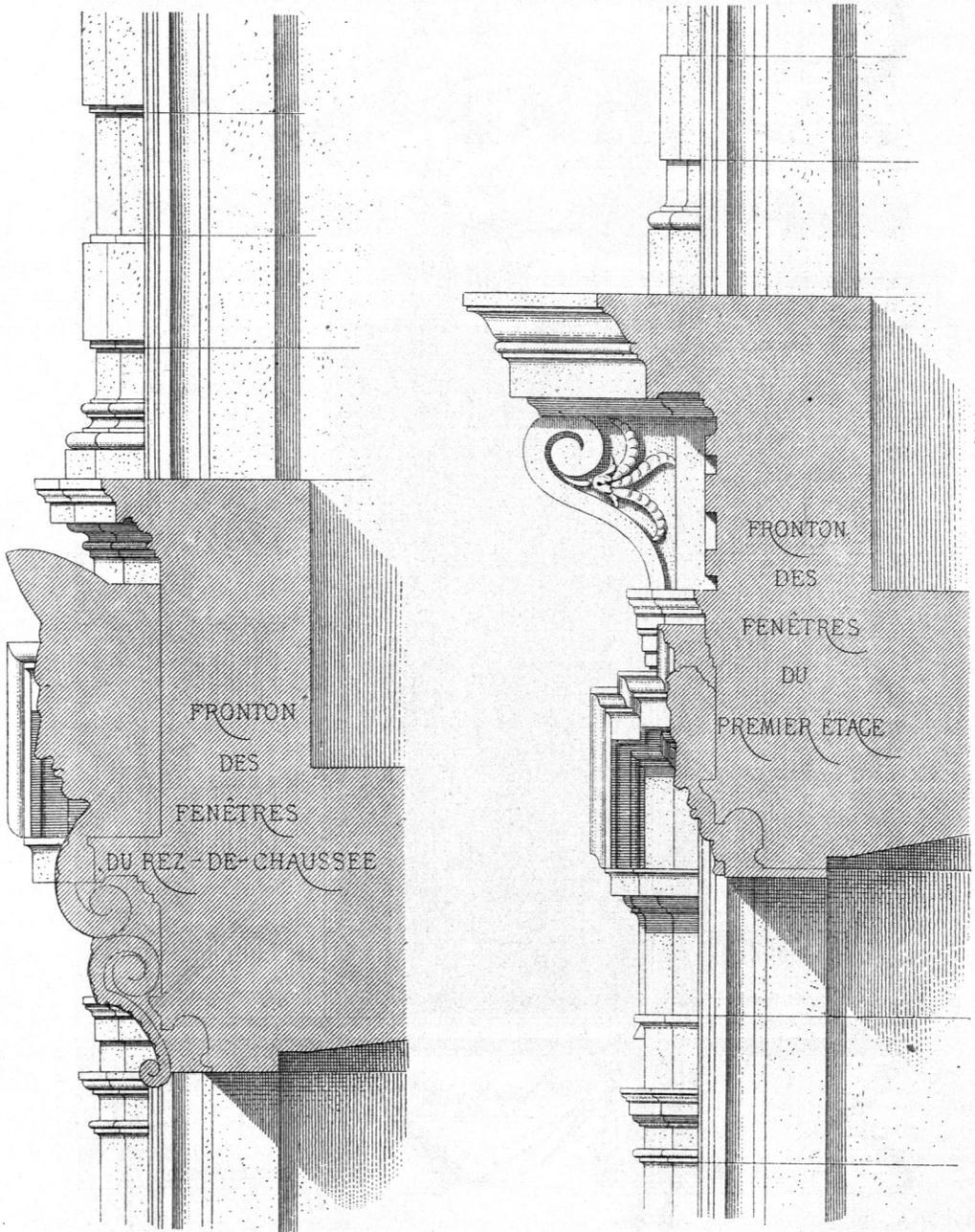
Einzelheiten der Fensterbedachungen in Fig. 208 u. 209<sup>99</sup>).
