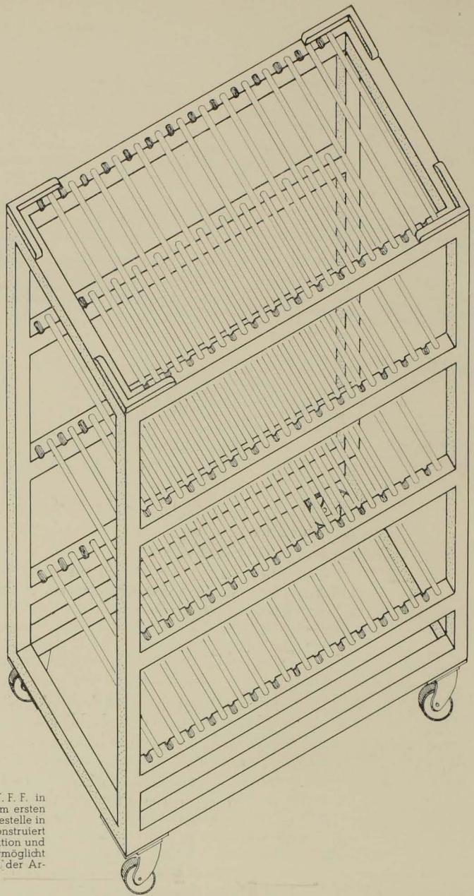
Abb. 17. HAUPTTRANSPORTGERÄT in der W. F. F. in Issehorst. Dieses fahrbare Gestell wurde hier zum ersten Mal als Ersatz der bisher üblichen feststehenden Gestelle in den Räucherkammern, im Lager usw., in Holz konstruiert und verwendet. Ergebnis: Bei einfachster Konstruktion und einschneidendster Verbesserung der Fabrikation ermöglicht es gelockerte Arbeitsweise bei straffster Reihung der Arbeitsabschnitte.
