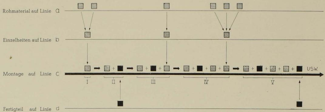
Abb. 12. SCHEMATISCHE DARSTELLUNG DES FORD-SAMMELSYSTEMS
