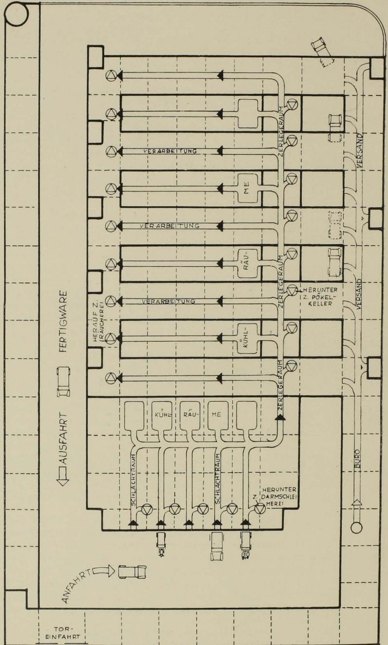
Abb. 5. ORGANISATIONS-PLAN DES ARBEITSLUSSSES zu dem Vorentwurf der geplanten Gesamtanlage der W. F. F. in Isselhorst.
