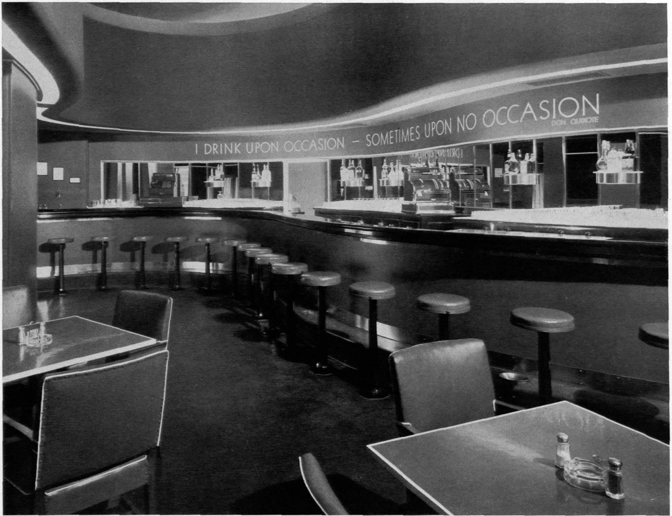
Die Morrison Hotel Bar in Chicago. Architekten Holabird und Root, Chicago. Leuchtband und Lüftung liegen in der herabgezogenen Rabitzdecke über der langen geschwungenen Bartheke. Hocker und Sessel haben helle Lederbezüge. An der Rückwand ein lakonischer Spruch aus dem Don Quixote. Unten der Grundriß 1:200 zum Bar-Restaurant „Blaue Donau“ auf der nebenstehenden Seite
