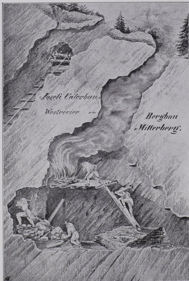
Fig. 1 Idealer Querschnitt eines Abbaufeldes (rechts) und eines Förderstollens (links), beide in Betrieb gedacht. Im Abbaufelde eine Feuerbühne aus Holz. Im Förderstollen Treppenhölzer auf der Sohle und ein hölzerner Handhaspel. (Nach einer Zeichnung PIRCHLS sen.)
