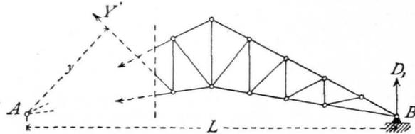
rechts vom Schnitte (Fig. 269); für dieses heißt die Gleichung der statischen Momente in Bezug auf den Punkt  $A$  als Drehpunkt
