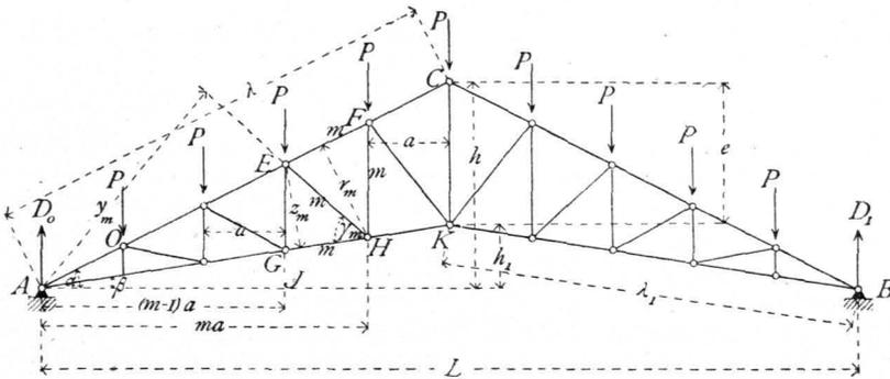
messen,  $a$ . Der Dachstuhl habe  $2n$  Felder; mithin ist  $L = 2na$ . Die Winkel der oberen, bezw. unteren Gurtung mit der Horizontalen seien  $\alpha$  und  $\beta$ . Die Auflager-
