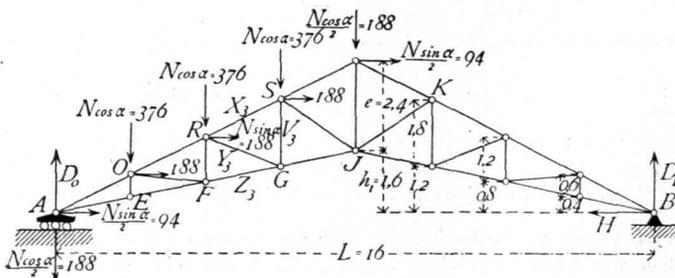
Die Spannungen in der Mittelverticalen (für  $m = 4$ ) sind nach Gleichung 301.  $V_4^g = 1950$  kg;  $V_4^p = 3657$  kg.
